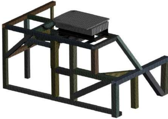
Şekil 6: Sürücü Koltuğu Bağlantı Karkasının Sonlu Elemanlar Ağı
