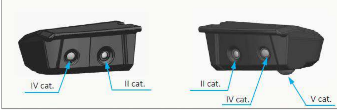
Şekil 4. Kamera Ünitesinde Kameraların Konumları
