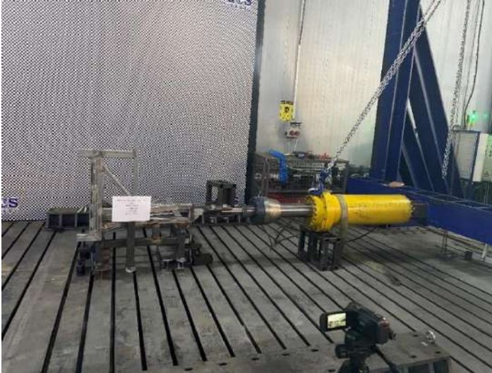
Şekil 7: ULTRA LF12 arka şasi tertibatı testi
