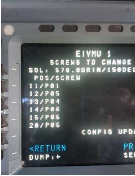
Şekil 5. MCDU Ağırlık Denge Vidaları Pozisyonu
