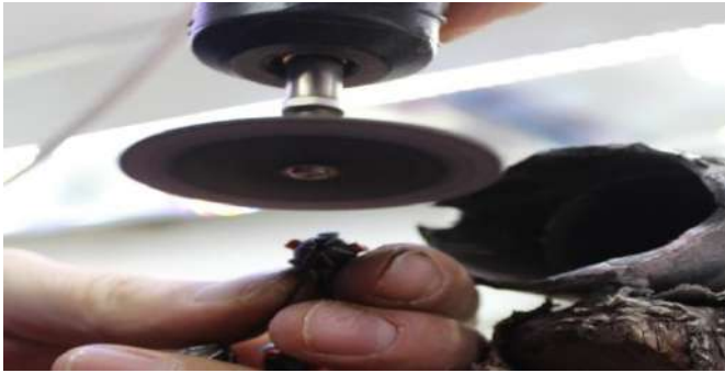
Şekil 16. Freze ile Zımparalama İşlemi (Kocaman, 2023)
