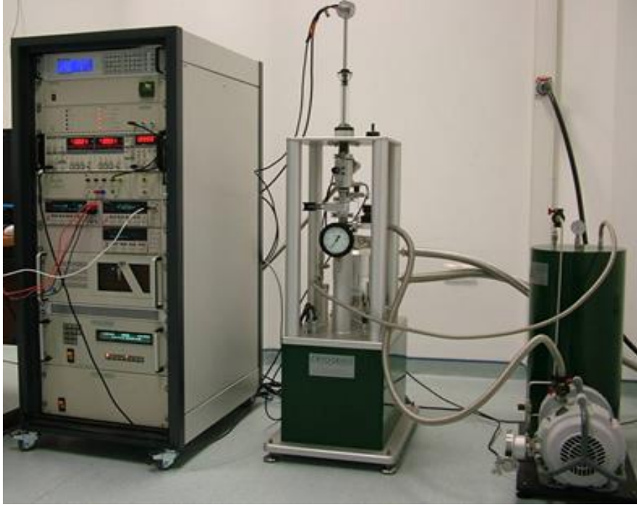
Şekil 2: VSM ölçüm için Cryogenic Limited PPMS cihazı (merlab.metu.edu.tr) (Şahin, 2019; Şahin , Emek ve Ibrahim, 2023)
