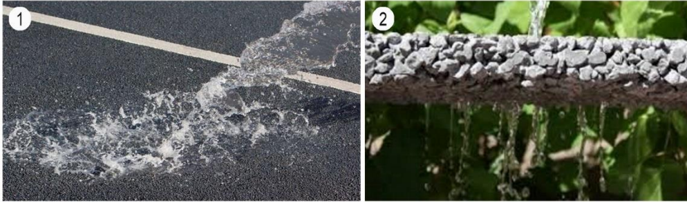
Şekil 10. Geçirimli asfalt ve geçirimli beton malzeme örnekleri (1. URL-11 Erişim tarihi 21.01.2024; 2. URL-12 Erişim tarihi: 11.01.2024)
