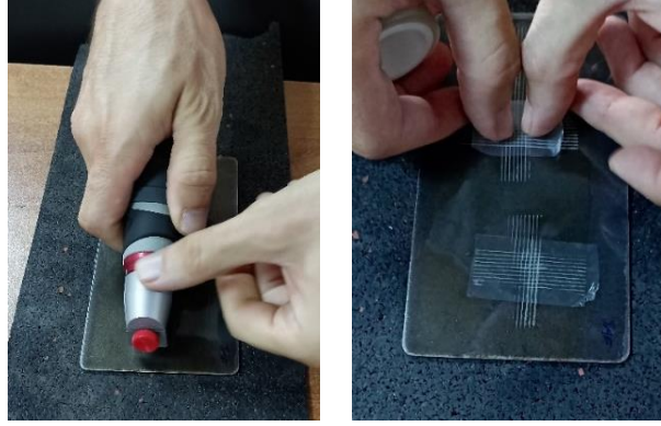
Şekil 4. Cross cut testinin uygulanması
