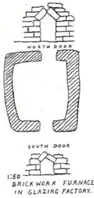
Şekil 8 Tell-el Amarna 'da Bulunmuş Olan Pişmiş Toprak Tuğla Fırının Petrie Tarafından Yapılan Çizimleri MÖ 1370 (Newton/ Davison 1989: 108). Antik dönem cam boncuklar (Taştemür, 2018).
