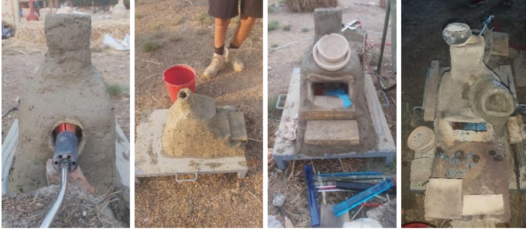
Şekil 26 Cam boncuk fırının yapım aşamaları (Kaynak: Ergün ARDA).
