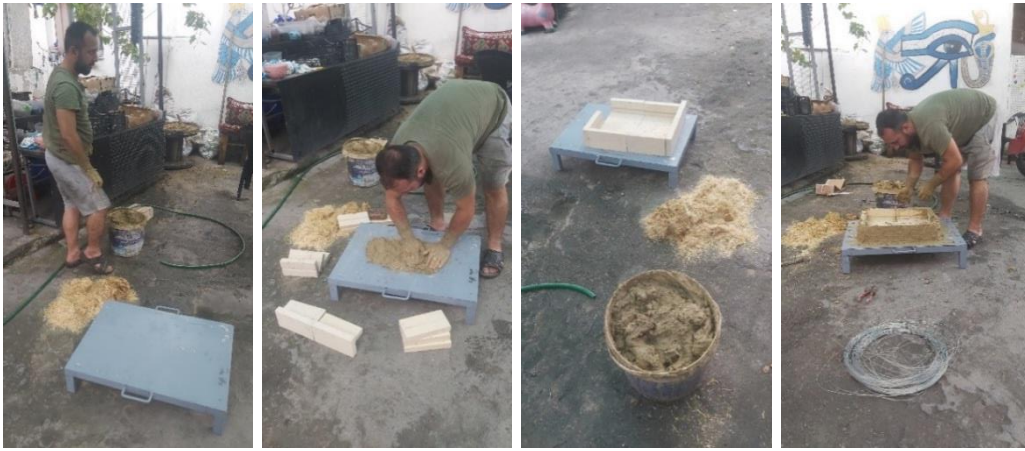
Şekil 21 Uğur usta ile gösteri amaçlı taşınabilir cam boncuk fırınının yapım süreci Kaynak: Ergün ARDA).
