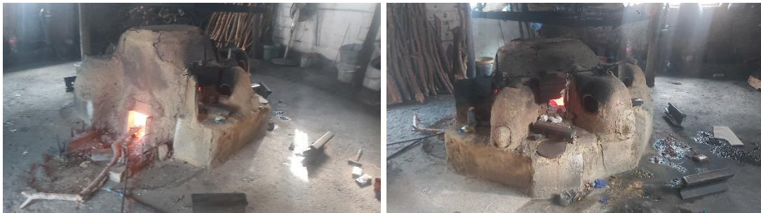
Şekil 18 Uğurlu Boncuk Cam Atölyesi’nin kullandığı geleneksel cam boncuk fırını (Kaynak: Ergün
