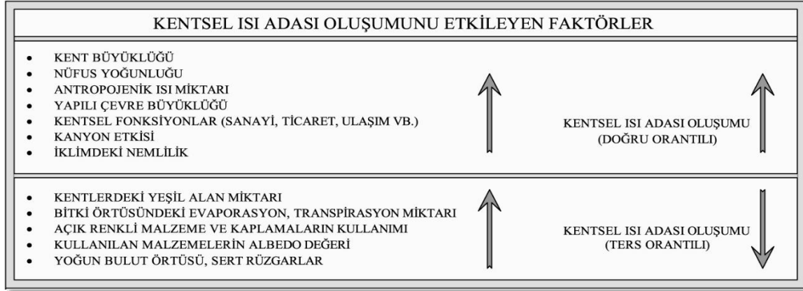
Şekil 13. Kentsel ısı adası oluşumunu etkileyen faktörler (Ekinci, 2016; EPA, 2008 kaynaklarından yararlanılarak derlenmiştir.)
