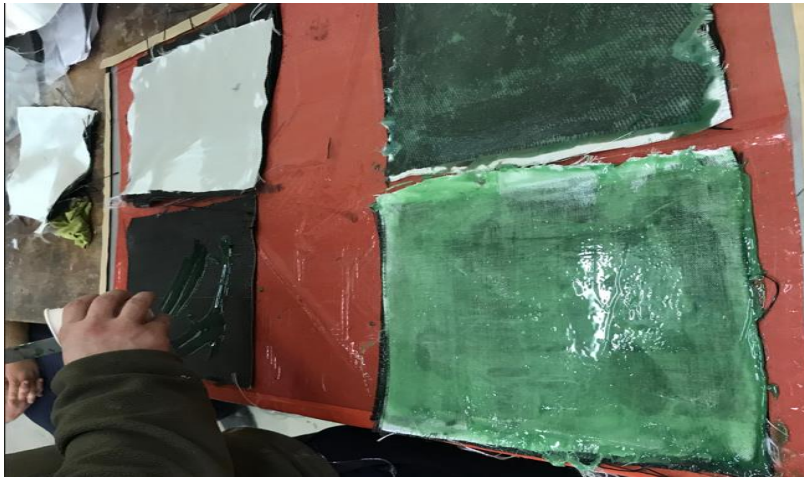
Şekil 1. El yatırması yöntemi ile reçine uygulaması
