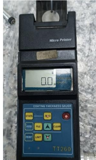
Şekil 3. Kaplama kalınlık ölçüm cihazı TT260 ve kaplama kalınlığı ölçümü
