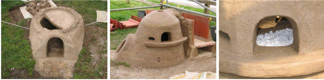
Şekil 13 Roma modeli tank tipi cam ergitme fırını örneği
