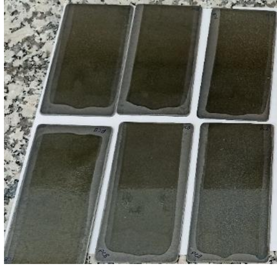
Şekil 2. Kaplama uygulanmış ve fırında kürlenmiş test plakası örnekleri.
