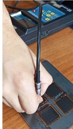
Şekil 3. Kaplama kalınlık ölçüm cihazı TT260 ve kaplama kalınlığı ölçümü
