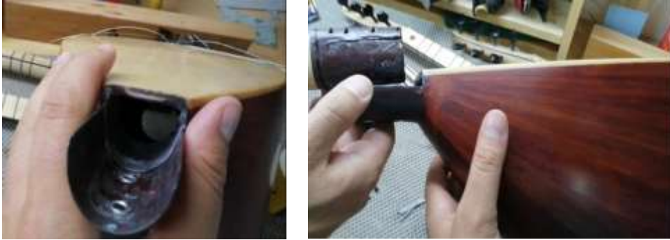
Őekil 2. Teknenin sap tarafına yerleřtirilen “U” řeklindeki metal aparat (Öztorun, 2022)
