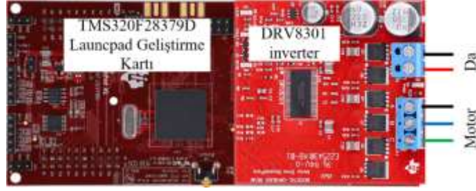
Şekil 9. TMS320F28379D DSP ve DRV8301 model üç fazlı sürücü
