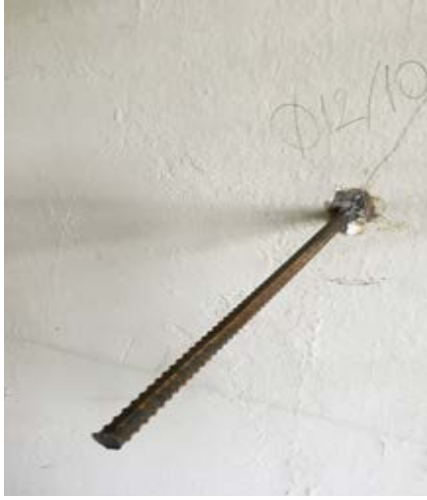
Şekil 6. a) TÇ ve b) KÇ Deneyleri Göçme Şekilleri
