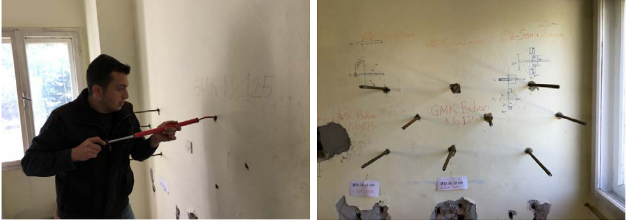
Şekil 3. Çekme-Çıkarma Deney Düzeneğini Hazırlanması ve Ankraj Ekimi
