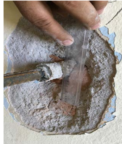
Şekil 7. Çekme-Çıkarma Deneyi Aderansta Göçme
