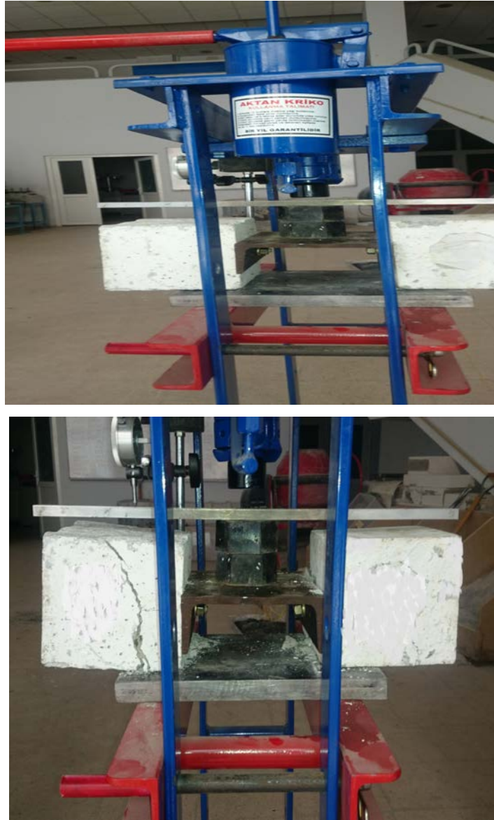
Şekil 2. Deney Düzeneği Deney Numunelerinin Yerleşim Düzeni ve Göçme Şekli
