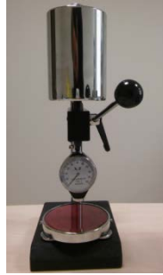
Şekil 1. Shore-D sertlik cihazı
