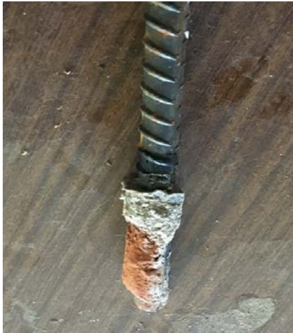
Şekil 7. Çekme-Çıkarma Deneyi Aderansta Göçme
