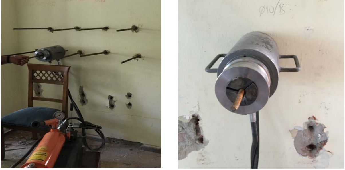
Şekil 5. TÇ Çekme-Çıkarma Deneyi
