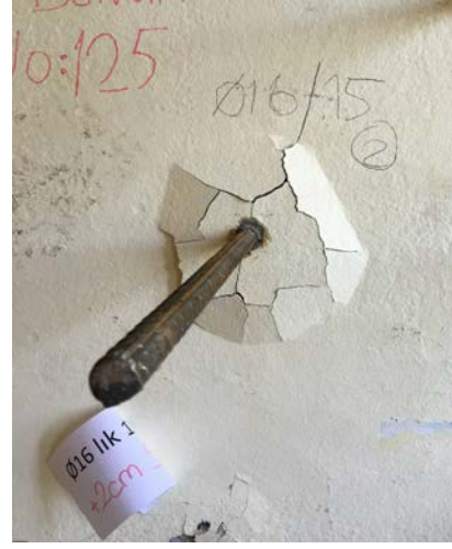
Şekil 6. a) TÇ ve b) KÇ Deneyleri Göçme Şekilleri
