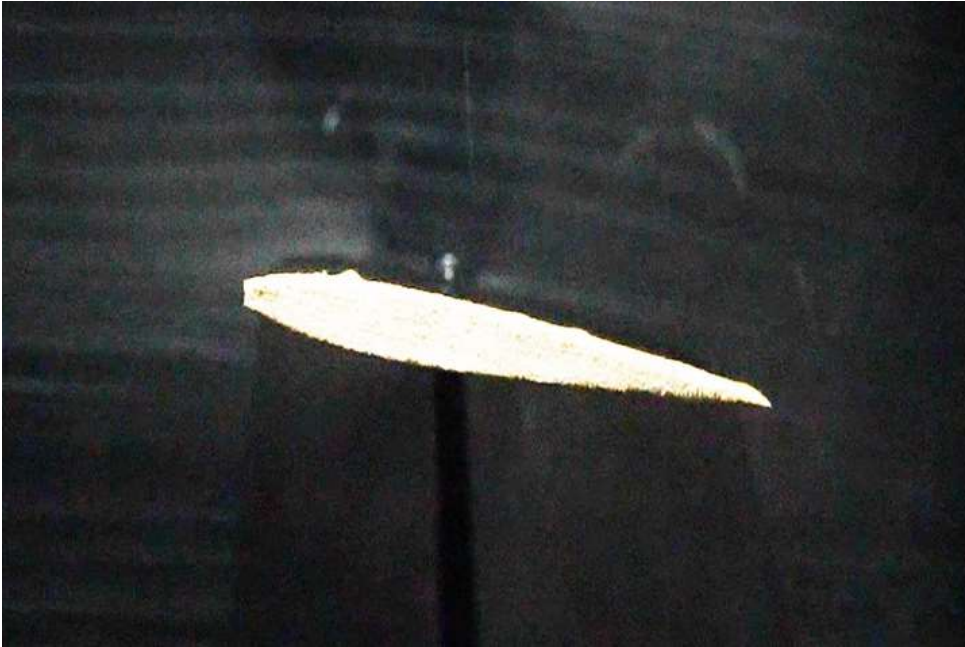
Şekil 5. Naca0008 kanat profili duman görüntüleme (Hücum Açısı 8^0 )
