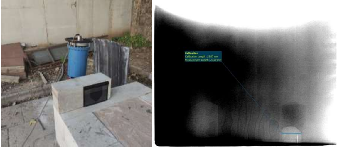
Şekil 6. Radyografi yöntemi ile teste tabi tutulan taş duvar ve radyografi görüntüsü
