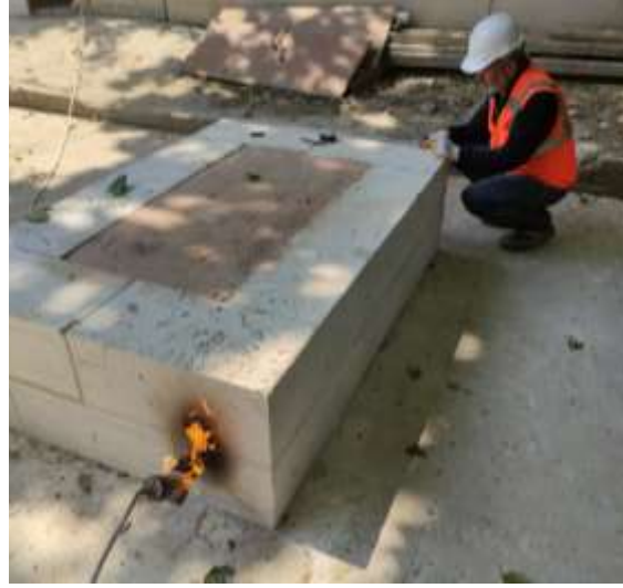
Şekil 1. Taş duvar deney düzeneği bünyesindeki demir elemanların ısıtılması
