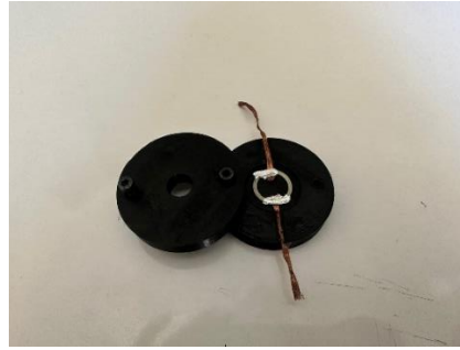
Şekil 1 İletken O-ring Kullanılan SRS Kristal Tasarımı
