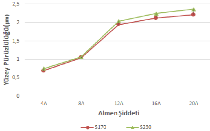
Şekil 4.2 S170 ve S230 Bilyeli dövme şiddetlerine bağlı olarak yüzey pürüzlülük değerlerinin karşılaştırması
