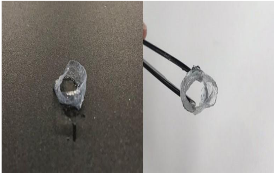
Şekil 2. Jelatin destek banyosu v0 ile basılan altıgenin çapraz bağlanma işleminden sonraki görünümü
