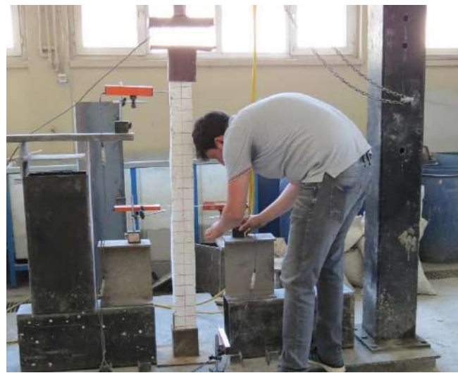
Şekil 2. Betonarme kolon deney ve ölçüm düzeneği
