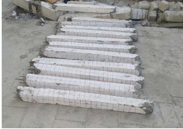
Şekil 8. Deney sonrası betonarme kolonlar
