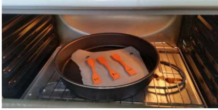
Şekil 3. Çekme test numunelerin 85 °C’de tavllanması
