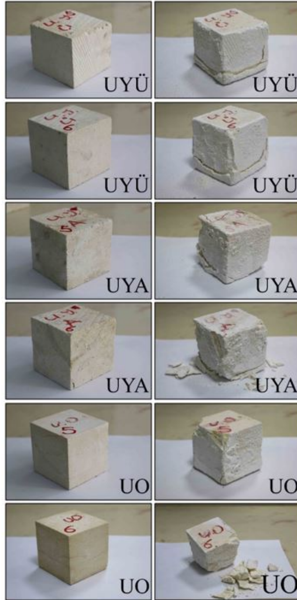
Şekil 13: Numunelerinin başlangıçtaki ve eskitme süreci sonundaki görünüşleri.
