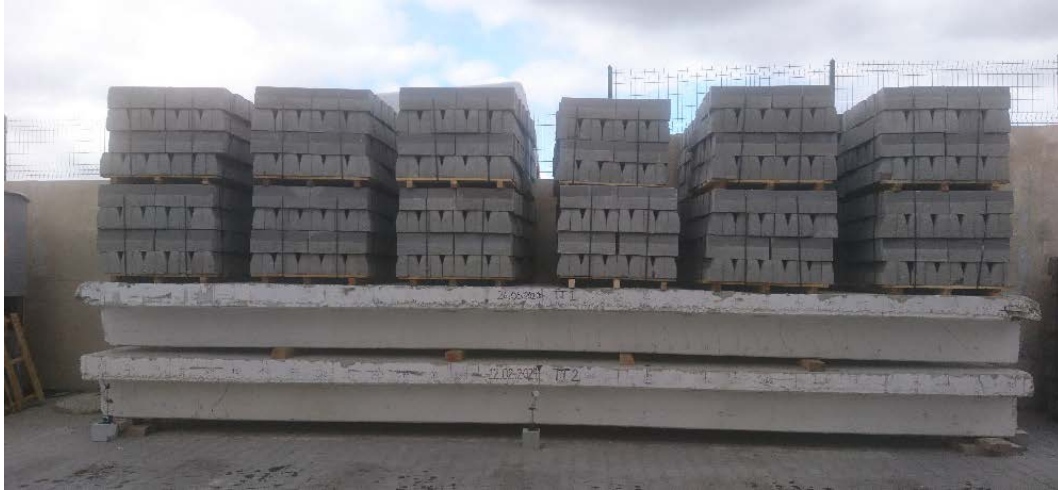
Şekil 11. İkinci TT-Kiriş ve 23 Bordür Paleti ile Yüklenmiş Durumu
