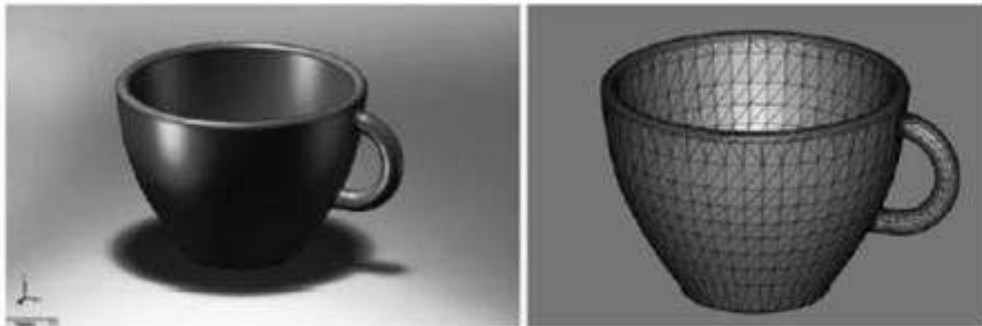
Şekil 1: Soldaki CAD modeli, sağdaki STL formatına dönüştürülmüş model (Gibson, Rosen, & Stucker, 2015)
