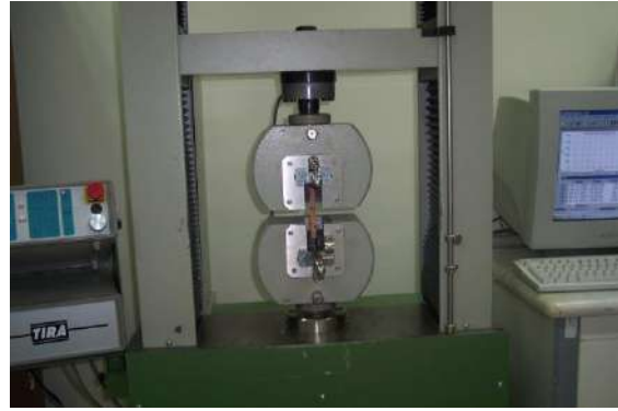
Şekil 2. (a) Liflere paralel basınç dayanımı ölçümü (b) Liflere dik basınç dayanımı ölçümü (c) Liflere paralel çekme gerilmesi ölçümü (d) Liflere dik çekme gerilmesi ölçümü
