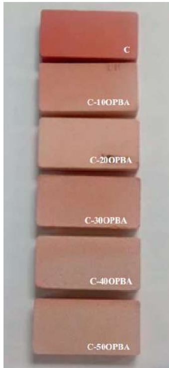
Şekil 5. Killi Tuğla (en üstte-C) ve Ağırlıkça %10-50 Oranında Pirina Külü İçeren Tuğla Numuneleri (Jose ve Castro, 2015)
