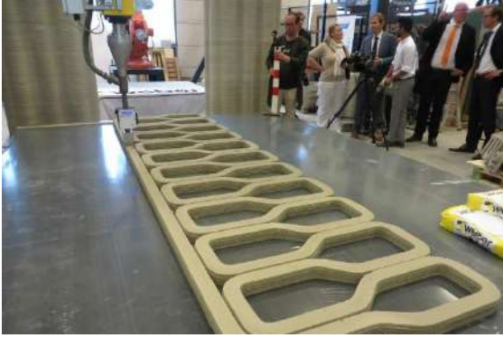
Şekil 13. 3D Köprü'nün basımı (BAM, 2017)
